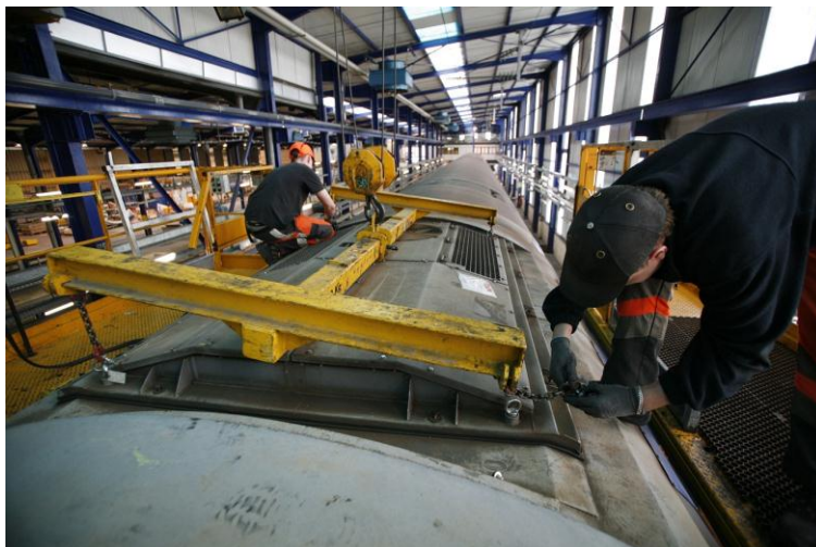
La modernisation des ateliers de Montrouge permet d'optimiser la maintenance des rames, en toiture et sous caisse
