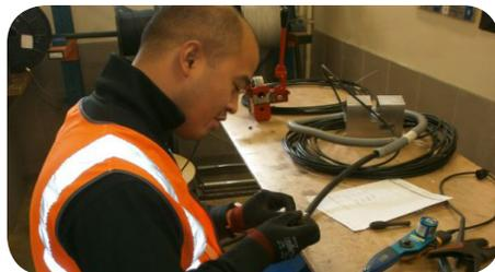
Assemblage des kits électriques des anti-enrayeurs
