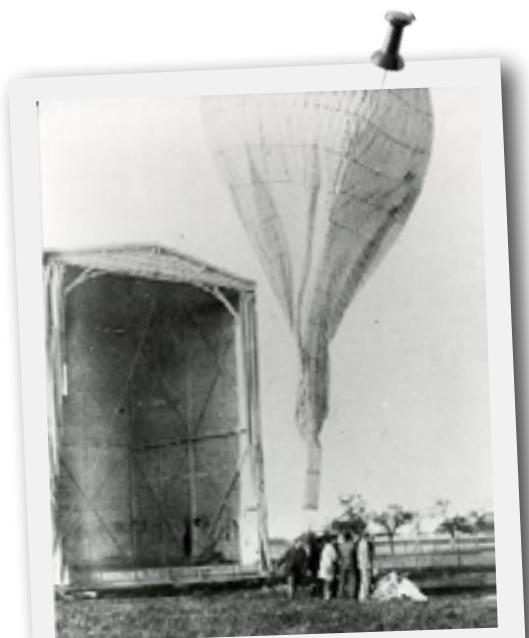
En 1897, Teisserenc de Bort s'est lancé dans l'exploration de l'atmosphère à l'aide de sondes de mesure (météorographes) de la température, de l'humidité et de la pression embarquées sur des cerfs-volants, puis des ballon-sondes à partir de 1898.
